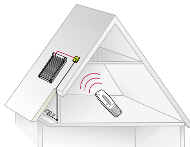
Anschlussbeispiel mit Elektro und Funk, Stecker werkseitig vormontiert, Anschluss an 230V Stromleitung.
