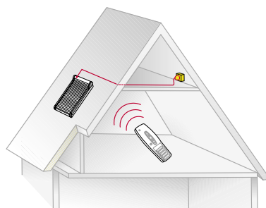
Anschlussbeispiel mit Elektro und Funk, Stecker werkseitig vormontiert, Anschluss an vorhandene Steckdose.
