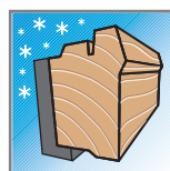
Profile aus Holz, mit vormontierter Wärme- dämmung
