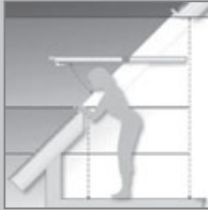
Der Schwachpunkt vieler Schwingfenster: Der Flügel steht genau im Blickfeld und erschwert den ungehinderten Zugang.
